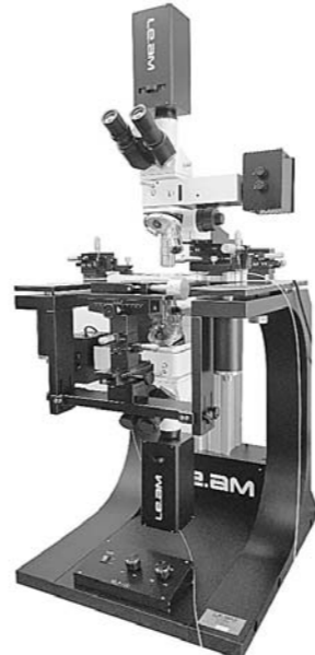
장초점 대물렌즈를 이용한 마이크로LED 특성 분석용 현미경
